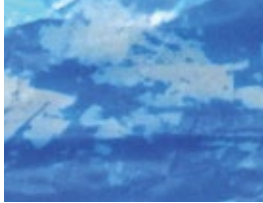
Schlechte Haftung bei durch Korona geschädigter Oberfläche
